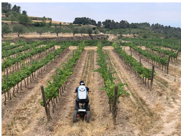
Figura 80. Mesura del dosser foliar amb un escàner terrestre mòbil basat en sensor LiDAR.
