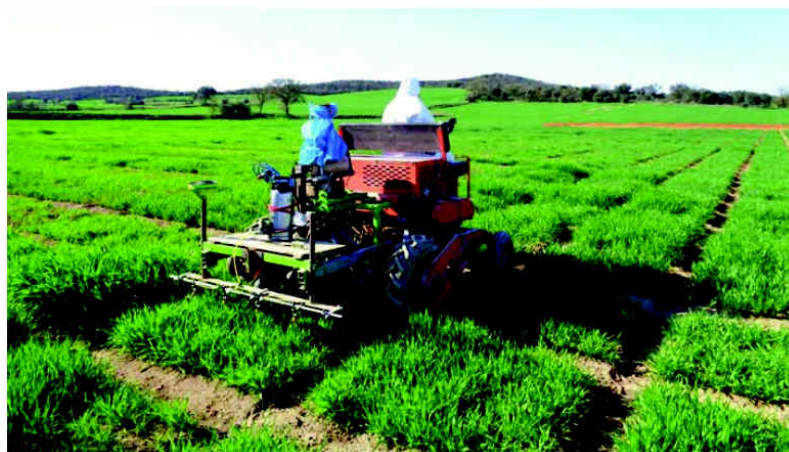
Foto 2. Pulverizador utilizado para la aplicación de herbicidas en el ensayo.
